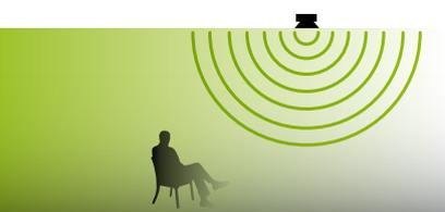
**Polar®-Lautsprecher** Kompromisslose 2-Wege-Einbaulautsprecher mit patentierter Polar-Technologie für extrem breite und gleichmäßige Schallabstrahlung (180°) für alle Frequenzen. Mit Polar-Einbaulautsprechern lassen sich Räume mit deutlich weniger Systemen und größeren Lautsprecherabständen homogen beschallen.
