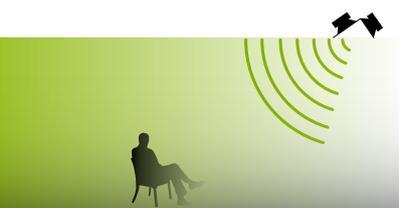
Das Modell **DE-X 300 FR** ist ein randloser Deckeneinbaulautsprecher mit definierter, 35° nach unten gerichteter Schallabstrahlung. Der DE-X 300 FR wurde speziell für den Einsatz als Front-Lautsprecher (L, R, Center) ohne Beeinträchtigung des Blickfeldes oder der Leinwand in Home-Audio-Anlagen und Medienräumen entwickelt.
